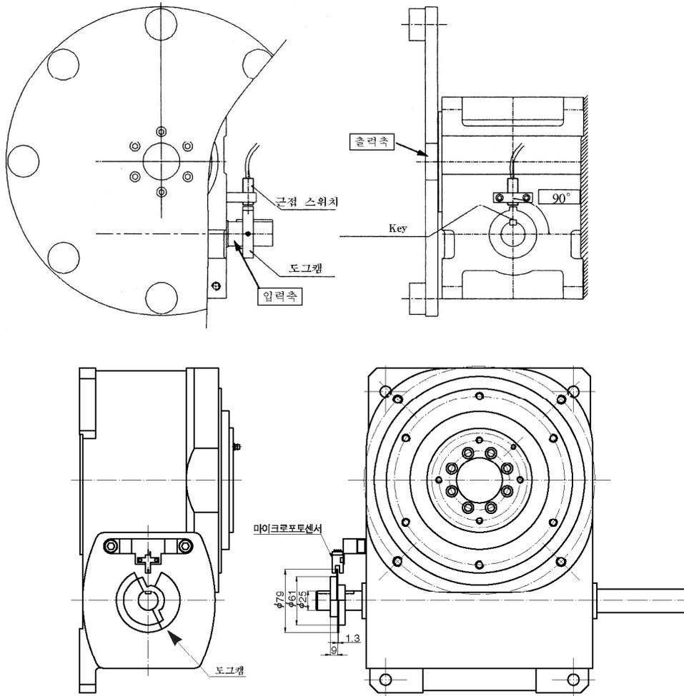
Handex는 밑면(W면)과 90° 위치가 정지구간의 1/2이 됩니다. 따라서 클러치나 브레이크 등으로 동력을 차단하기 위한 스위치를 설치하기 위해서는 위의 그림과 같이 설치를 해야만 됩니다.
